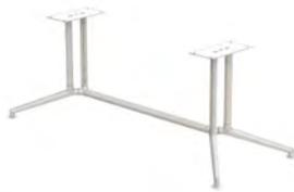
Montants verticaux en profil d'acier ép. 1,5 mm, section 40×40, greffés sur pieds en fusion de ZaMa. Plaque d'acier pour la fixation au plateau dans la partie supérieure. Les pieds sont liés entra eux par un longeron en profil d'acier ép. 1,5 mm section 40 × 40. Tout est verni à poudre époxy.
