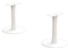
Tige en tube d'acier Ø 100 mm conique dans la partie inférieure et supérieure Ø 140 mm; plaque supérieure en acier pour fixation au plateau; base inférieure en tôle d'acier imprimée ép. 6 mm Ø 590 mm. Tout est verni à poudre époxy. Base inférieure avec joint transparent.
